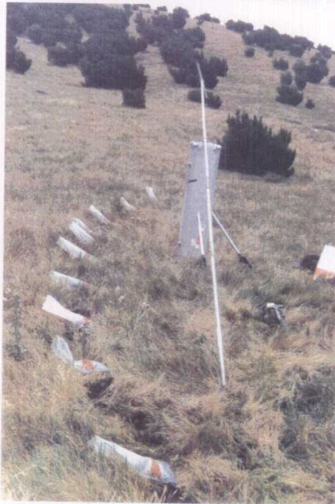
Fig. 5.1. Ejecución del sondeo S1 para la realización de la descripción litológica y toma de muestras de suelo
